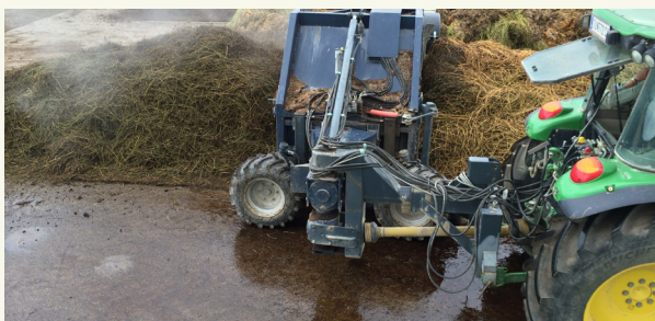
1. ábra: Az alapanyagok homogenizálása termofil komposztálás céljából komposztforgató segítségével
