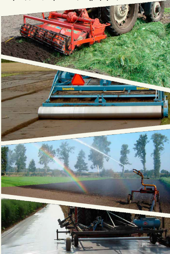
Εικ. 1: Αναερόβια απολύμανση εδάφους με μια ματιά (από πάνω μέχρι κάτω): Ενσωμάτωση φρέσκια οργανικής ύλης Κλείσιμο επιφάνειας Βρέξιμο εδάφους Κάλυψη με VIF
