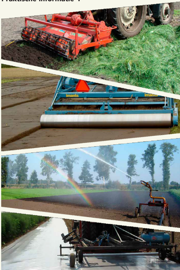
Afb. 1: Anaerobe Grondontsmetting in één oogopslag (van boven naar beneden): Inwerken van vers organisch materiaal Afsluiten van het oppervlak Bevochtigen van de bodem Afdkking met vrijwel ondoorlaatbare folie (VIF)
