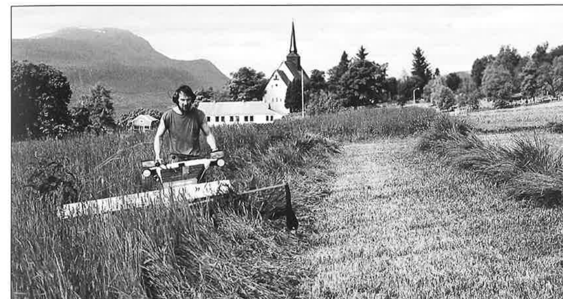
Tohjulstraktoren fungerte godt på steder som dette og la opp perfekte og vel avgrensede strenger. De som prøvde utstyret var imidlertid enige om at det ofte ble for tungt arbeid. Legde i graset, stor avling eller kort gras medførte at det ofte ble stopp for å fjerne gras som satte seg fast. I bakker var det tungt å styre.
