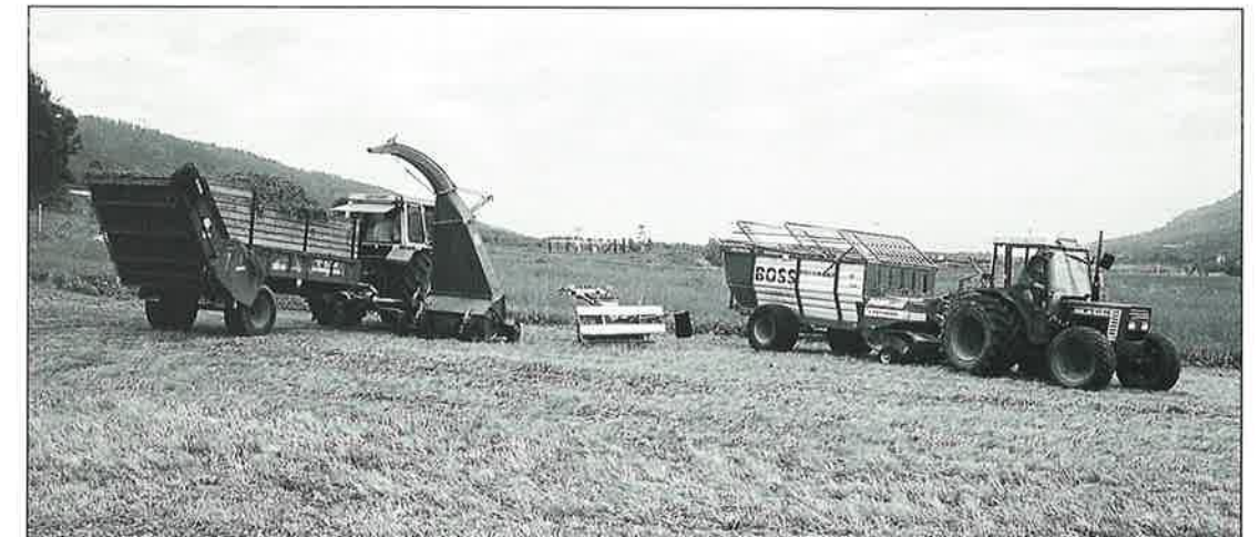
Maskiner og redskap som ble brukt i feltforsøket. Til direktehøsting ble traktor med fôrhøster og avlesservogn brukt (til venstre). I midten tohjulstraktoren med slåmaskin og skårlegger, og til høyre traktor med lessevogn brukt til totrinnshøsting. Begge firehjulstraktorene er utstyrt med spesielt breie dekk med lavt lufttrykk.
