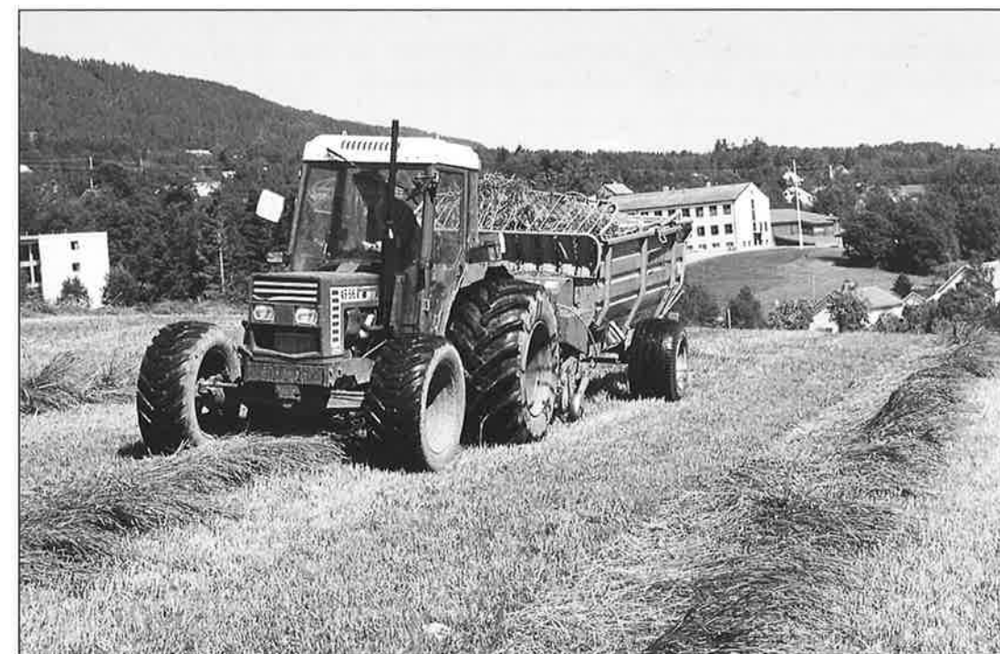
Oppsamling av graset fra strengene med lessevogn. Med 3,7 meter mellom strengene ble det lite kjøring på enga og dermed mindre pakking enn ved direktehøsting.
