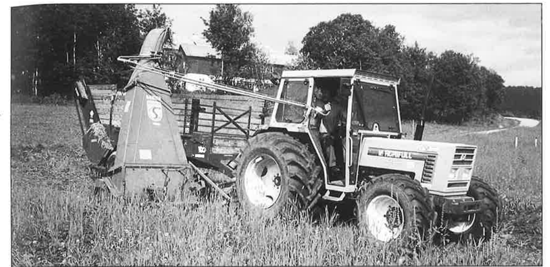
Direktehøsting med fôrhøster var mer arbeidskrevende og hadde større dieselforbruk enn tottrinshøsting. Arbeidsmiljøet var heller ikke godt, med sterk støy og tung styringsmekanisme på fôrhøsteren.
