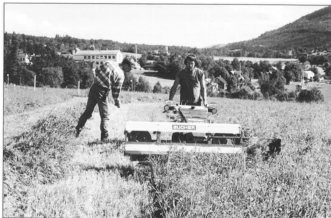
Tohjulstraktoren med slåmaskin og skårlegger. Knivbjelken var hele 1,9 meter bred. Prosjektlederen sjekker at forsøket blir utført i tråd med forutsetningene.
