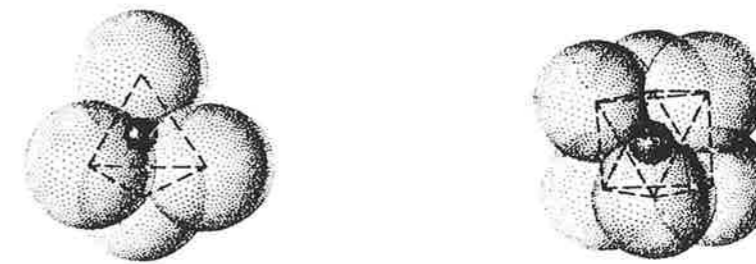
Figur 2. Si-tetraeder (SiO 4 ), til venstre og Al-oktaeder (Al(O,OH) 6 ). Disse molekylene er byggesteiner i primære alumosilikater (mineraler) og leirmineraler. Scheffer & Schachtschabel 1982.
