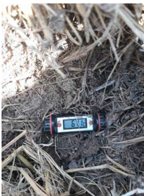
Figura 5: Medición de la temperatura de las pilas experimentales y divulgativas.
