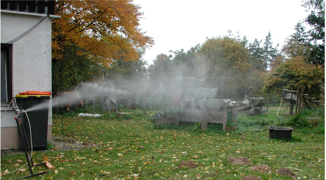
*Test einer Zerstäuberdüse zur Ausbringung des Kieselpräparates*
