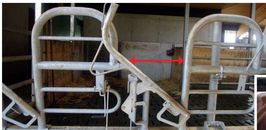
Ein großer Öffnungswinkel (oben) begünstigt im Vergleich zu einem schmalen Öffnungswinkel (rechts) ein schnelles Verlassen des Fressgitters.
