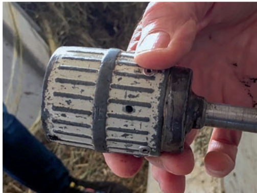
Bearbeitung der Hornspitzen bei besonders aggressiven Tieren (z. B. Kürzen, Abfeilen) beispielsweise mit Hilfe eines Aufsatzes für den Akkuschrauber.
