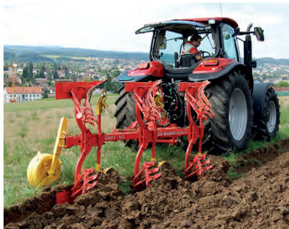
Используя специальный полунавесной оборотный плуг (on-land), можно выйти за рамки борозды. Этим предотвращается уплотнение подпочвы, скольжение и образование плужной подошвы.
