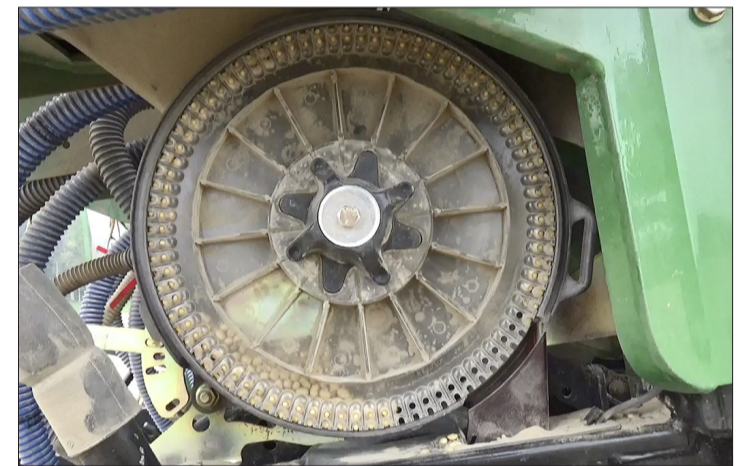
Sämaschine für Soja, pneumatische Sämaschine. (Bild: FiBL)
