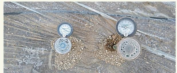
Fig. 1: Tensiómetros para medir la humedad del suelo durante la solarización. El de la izquierda se encuentra a 15 cm de profundidad y el de la derecha a 35 cm de profundidad.
