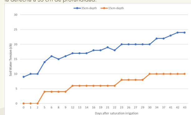
Fig. 2: Evolución de la tensión matricial del suelo durante la solarización a dos profundidades.
