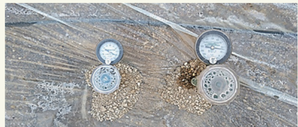
Billede 1: Tensiometre til at måle jordfugtigheden under solarisation. Den til venstre er placeret i 15 centimeters dybde, og den højre i 35 centimeters dybde.
