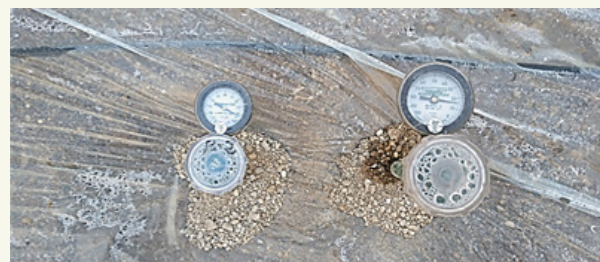
Obr. 1: Tenzometry pro měření vlhkosti půdy během solarizace. Levý je umístěn v hloubce 15 cm a pravý v hloubce 35 cm
