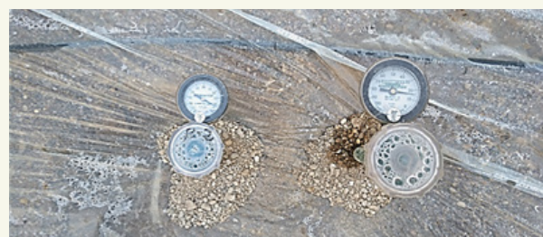
Slika 1: Tenzimetri za merenje vlažnosti zemljišta tokom solarizacije. Levi je postavljen na 15 cm a desni na 35 cm dubine zemljišta.
