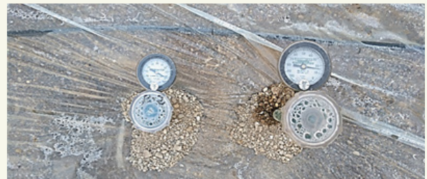
Slika 1: Tenziometra merita nivo vlage v tleh med solarizacijo. Levi je nameš en na globino 15 cm, desni pa na globino 35 cm.
