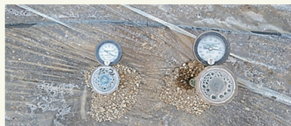
Imagine 1: Tensiometre pentru măsurarea umidității solului în timpul solarizării. Cel din stânga este plasat la 15 cm adâncime, iar cel din dreapta la 35 cm adâncime.
