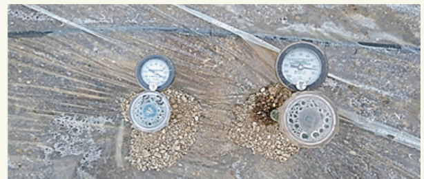
Imagem 1: Tensiómetros para medir a humidade do solo durante a solarização. O esquerdo é colocado a 15 cm de profundidade e o direito a 35 cm de profundidade.
