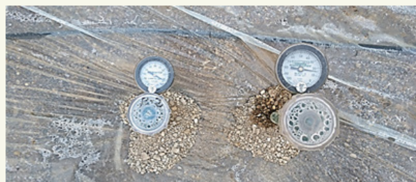
Obraz 1: Tensjometry do pomiaru wilgotności gleby podczas solaryzacji. Lewy jest umieszczony na głębokości 15 cm, a prawy na głębokości 35 cm
