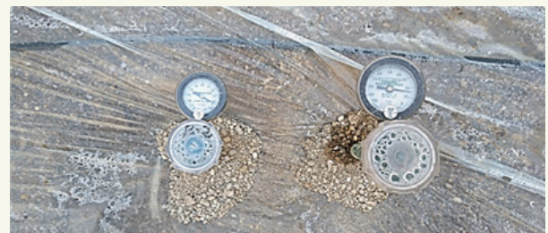
Fig. 1: Tensiometers voor het meten van de bodemvochtigheid tijdens de solarisatie. De linker wordt op 15 cm diepte geplaatst en de rechter op 35 cm diepte.
