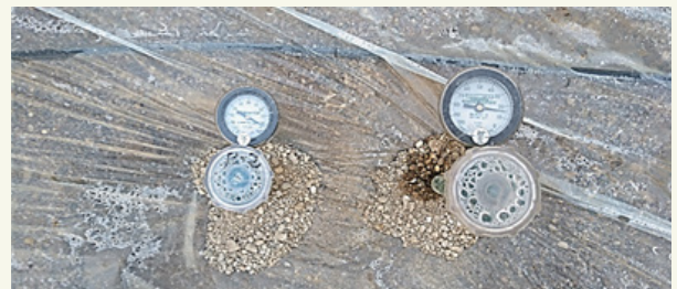
1. attēls. Tensiometri augsnes mitruma mērīšanai saules starojuma laikā. Kreiso novieto 15 cm dziļumā, bet labo - 35 cm dziļumā.
