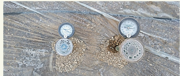
1 pav. Tensiometrai dirvožemio drėgmei matuoti atliekant dirvožemio solarizaciją. Kairysis įterptas 15 cm gylyje, o dešinysis - 35 cm gylyje.
