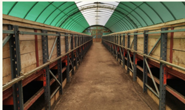
Slika 2: Stalni protok: Oprema za vermikompostiranje u zatvorenom prostoru, Austrija
