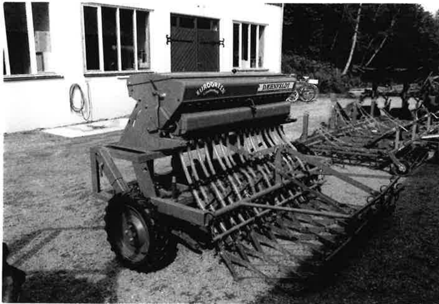
Figur 2. Maskin for direktesåing av grasfrø i eng
