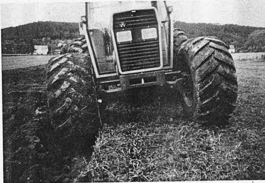
Hjulavstanden mellom forhjula bør være 10-15 cm større enn mellom bakhjula ved pløyning med brede lavprofildekk. (Foto: Jan-Erik Mæhlum)
