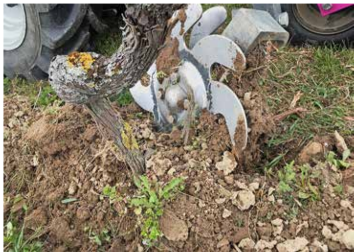
Travail de désherbage mécanique à l'aide de disques dans la vigne.
