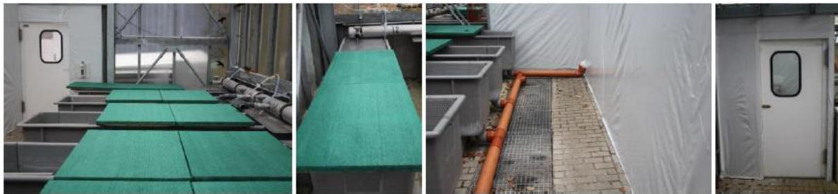
Abbildung 13: Hälterrinnen mit Durchflusssystem in abgeschlossenem Quarantäne-Bereich für Challenge-Experimente.
