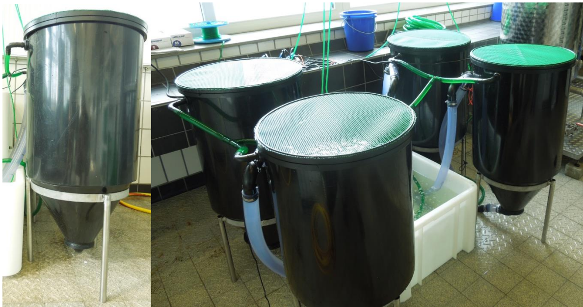
Abbildung 2: Rundstrombecken, die zur Haltung der Fische in den Filtrationsversuchen verwendet wurden. Jedes der Becken hat ein Fassungsvermögen von 100 Liter und einen konisch zulaufenden Boden, an dem sich ein Ablauf befindet.
