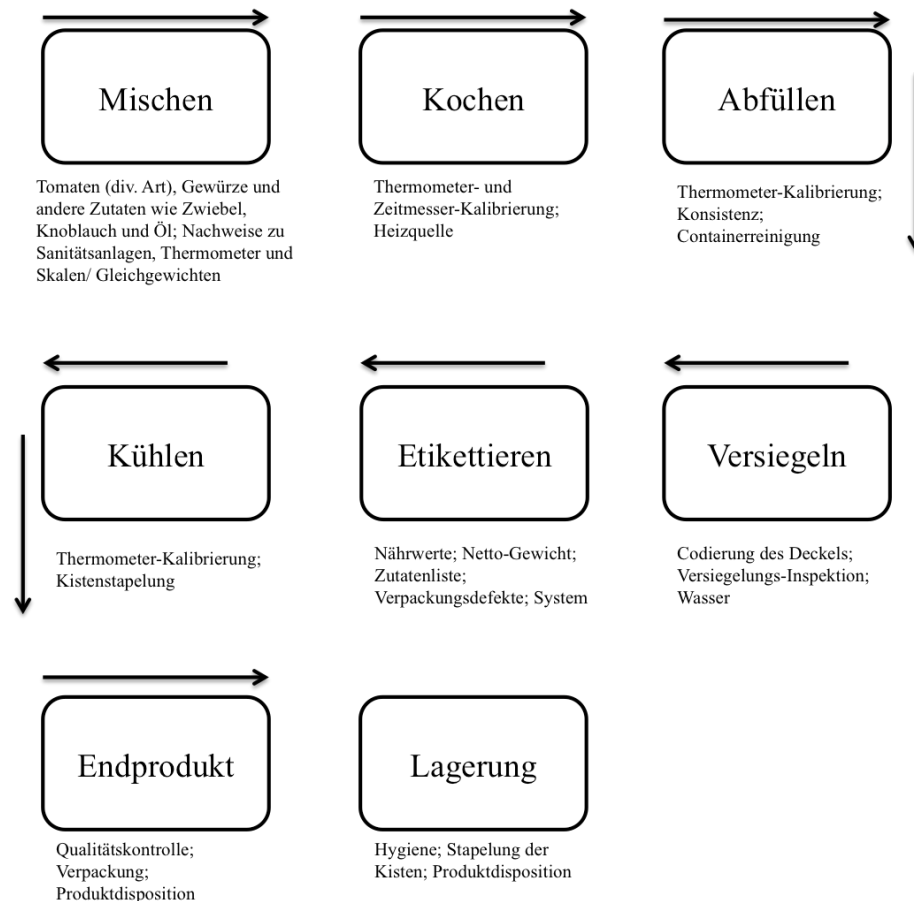
Abb. 5: Darstellung der operationalisierten Prozesseinheiten von Tomatensauce im Flussdiagramm; untenstehend ihre Durchführungsparameter (eigene Darstellung nach VASCONCELLOS, 2005, 190ff)
