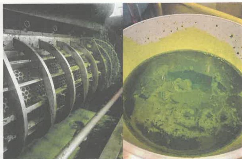
Plantesaft presset ud af frisk høstet Lucerne i en skruepresse i pilotanlæg
