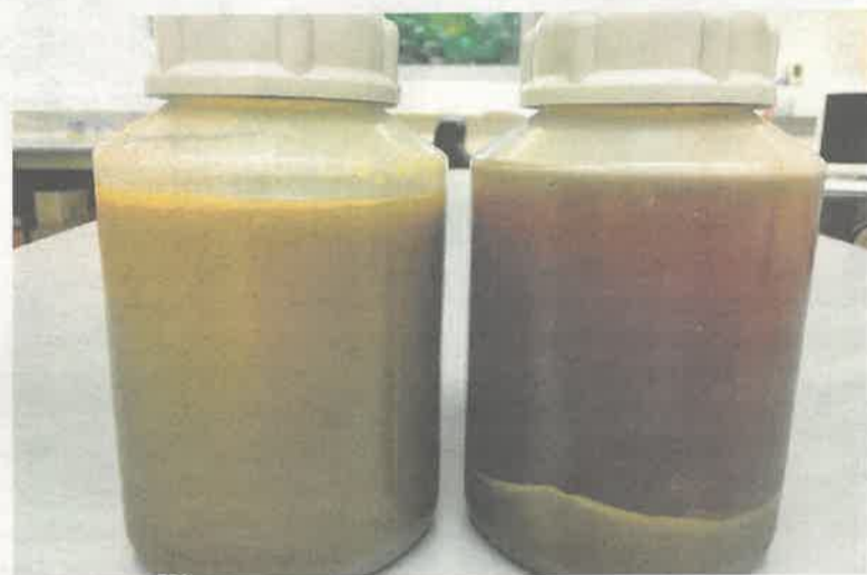
Fældning af proteiner efter centrifugering af plantesaften, der er syret med mælkesyrebakterier
