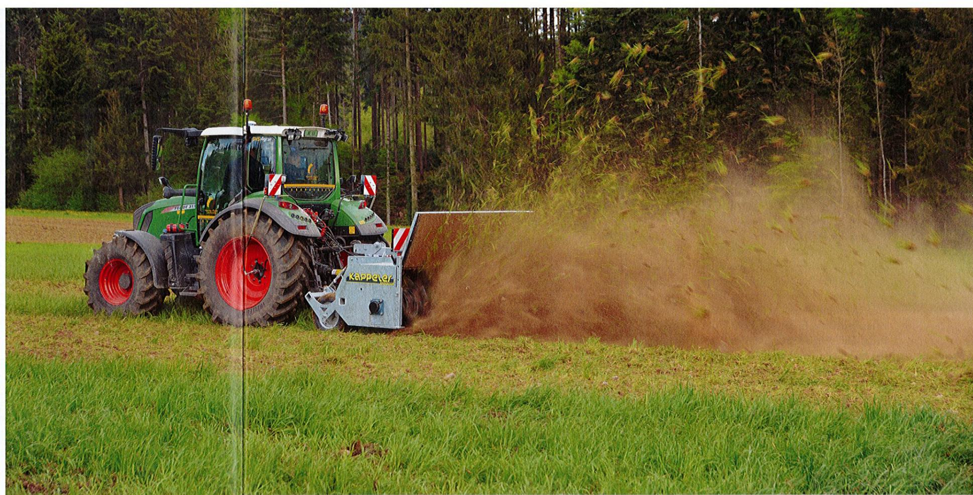
Der Biorotor löst die Wurzeln der Gräser bei geringer Arbeitstiefe. Dabei werden die Wurzelteile und die Erde intensiv getrennt. Die Pflanzenteile werden weiter geschleudert als die Erdteile und liegen oben auf. Dort trocknen sie rasch aus.
