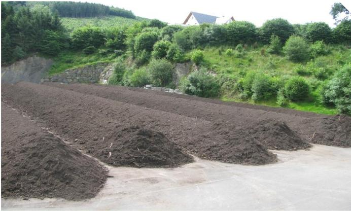
Abb. 1: Dreiecksmieten in einer Anlage zur Grüngutkompostierung
