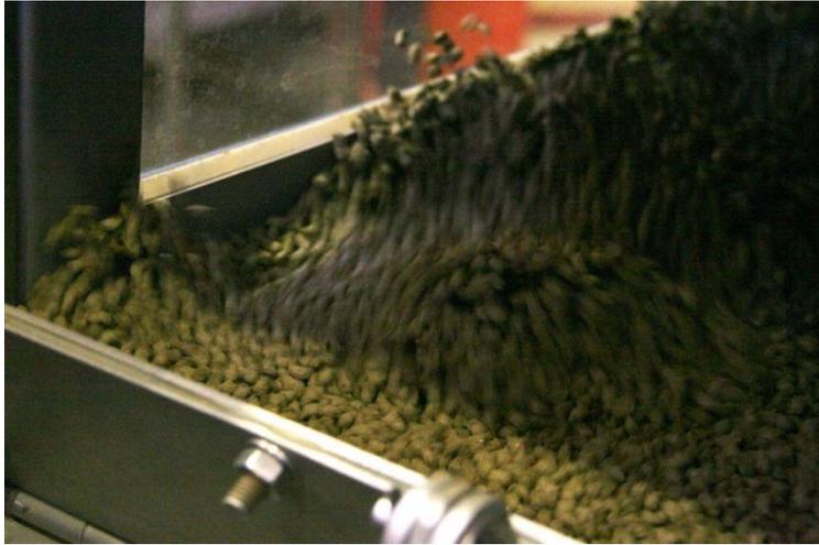
Abbildung 8: Nahaufnahme der fluidisierten Futterpellets während der Trocknung.
