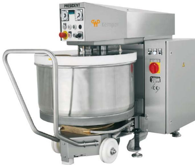
Abbildung 10: Spiralknetzer „President“ der Firma „Kemper“ in dem der Coatingprozess der Futterpellets durchgeführt wurde.
