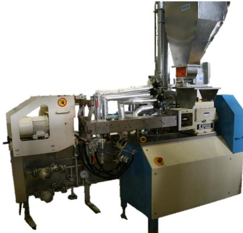
Abbildung 6: Bühler 2 – Wellen – Extruder DNDL – 44
