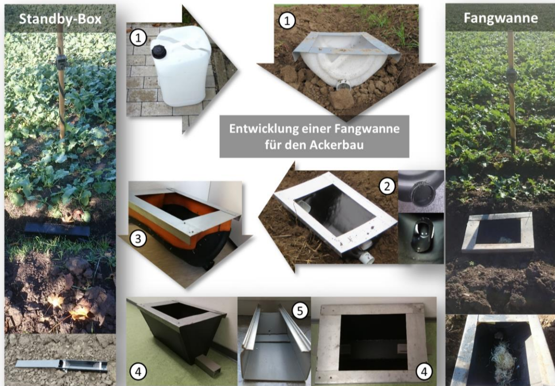
Abbildung 3.1: Selbstbedienungsfallen für Prädatoren, die Kleinsäuger fangen, von Prädatoren kontrolliert und entleert werden. Als Vergleich in Feld- und Gehegeversuchen diente die Standby-Box (Andermatt Biocontrol AG). Die Fangwanne wurde folgendermaßen entwickelt: 1) Plastikkanister (25 l) wurden diagonal geteilt, damit die Fangwanne an die dreieckige Form der Pflugfurche angepasst ist. Im Laufe der Feldversuche wurde die Fangwanne verbessert: 2) Wechsel von Gittertüren zu Plastik-Schwingtüren; schwarze Färbung; 3) Erhöhung der Fangwanne um 70 mm; 4) Prototyp mit eckigen Einlauffröhen und 5) einer Verlängerung an der Plastik-Tür, auf der die Feldmäuse in der Falle sitzen und deshalb die Tür nicht anheben können. (Fotos: JKI, A. Schlötelburg)
