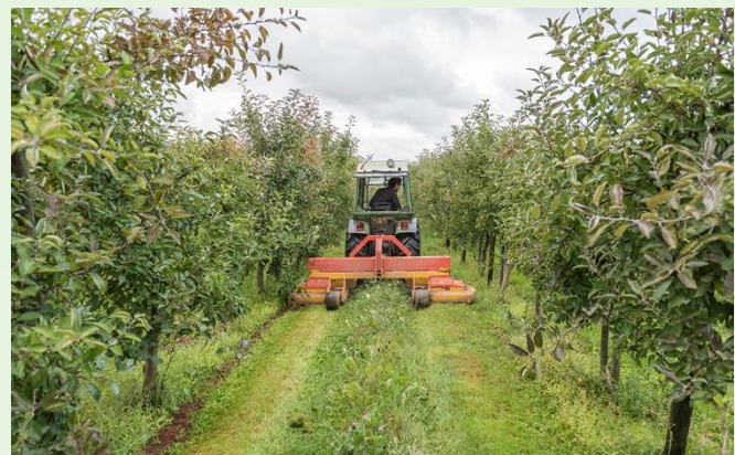
Abb. 2: Einsatz eines Blühstreifenmulchgerätes zur Pflege der Fahrgassen
