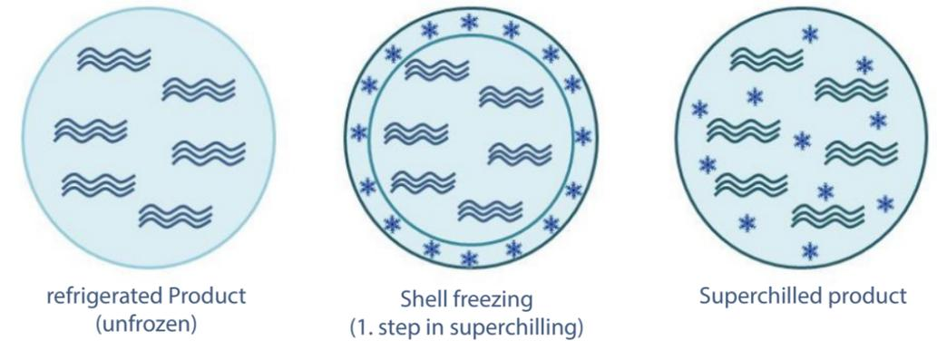
Figura 1.4: Le diverse fasi del super riscaldamento degli alimenti: l'acqua presente nel prodotto è parzialmente congelata e dopo un certo periodo di tempo è presente una miscela di acqua e ghiaccio all'interno della struttura del prodotto.
