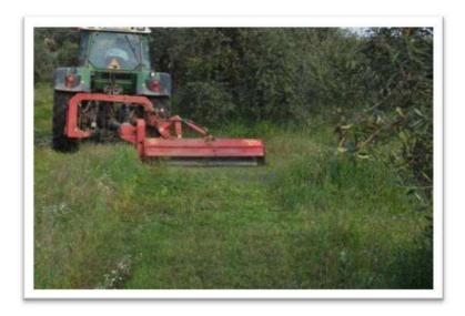
Figure 2 6 Taglio dell'erba (seminata + spontanea) e triturazione con trincia meccanica a lame a martello
