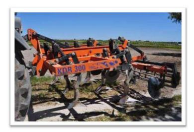
Figure 2 2 Maccbina combinata combinata di ancore a molla con dischi frangizolle incorporati per preparare il terreno con pochi passaggi e minor consumo di carburante e di energia
