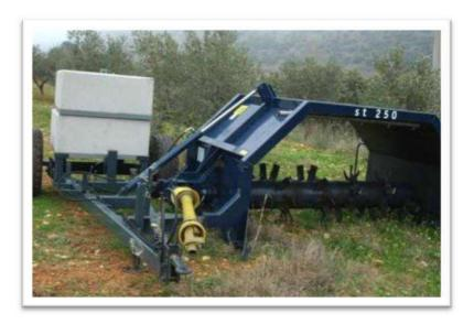
Figure 2 9 Attrezzatura per la miscelazione e l'aerazione del compos
