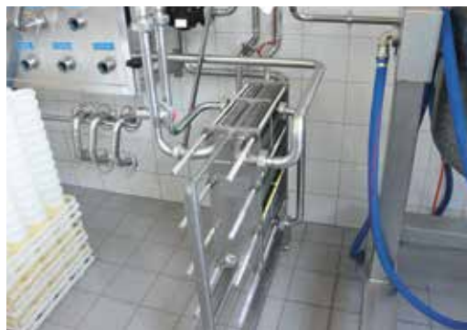
Le lait est tempéré à 65 degrés – c'est la seule transformation entre la traite et la fabrication du fromage.
