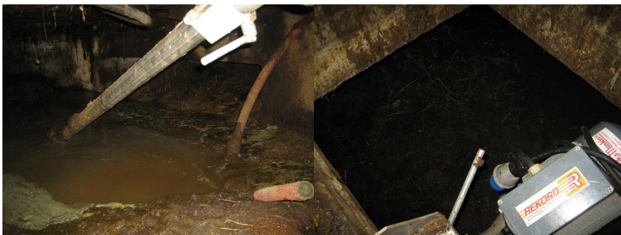
Figur 6. Propell (1) fastmontert ved enden av gjødseltrekket september 2014.
