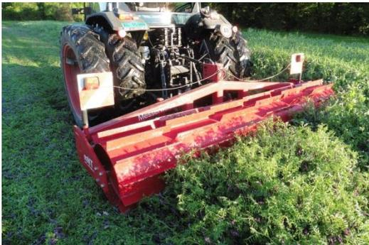
**Abbildung 11: Tiefenlockerung beim Mulchsaatverfahren mit Löwenzahn und Rototiller (Rümikon 2017)**
