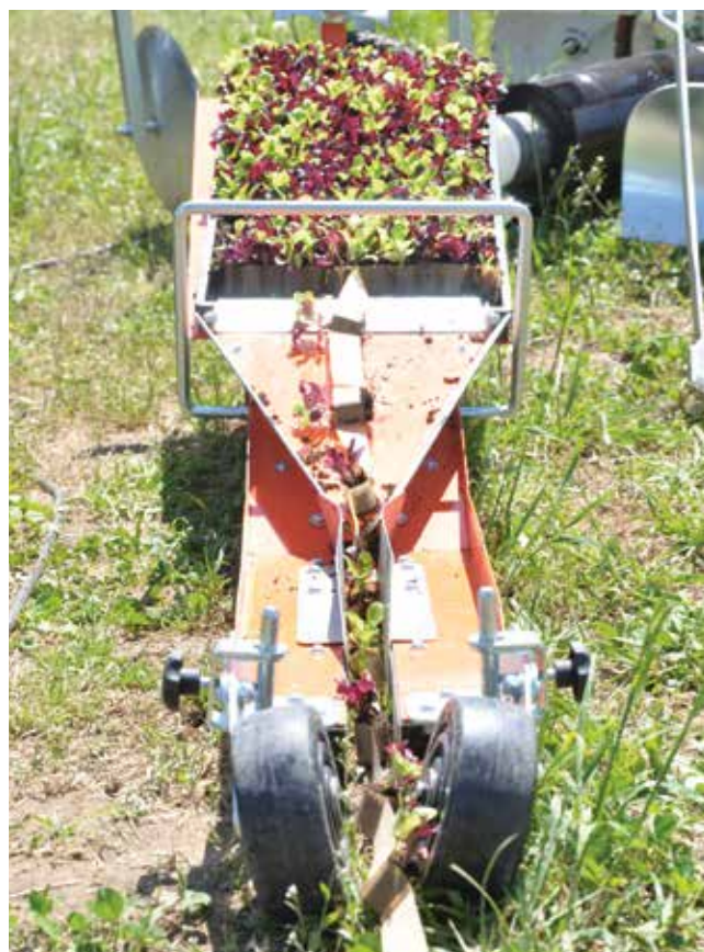
L'innovation reste de mise dans la micromécanisation, comme ici cette repiqueuse manuelle de plantons en paper pots. Photo: Matthias Klais
