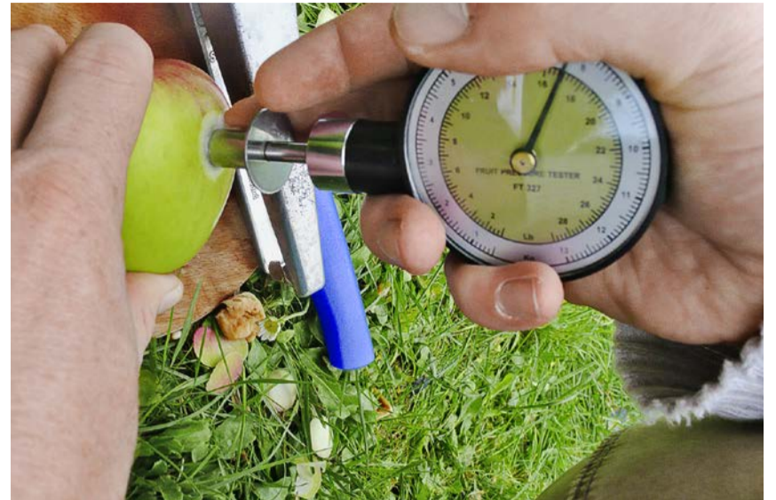
Mit Hilfe eines Penetrometers kann die Fruchtfleischfestigkeit bestimmt werden. (Bild: © FiBL, Andi Häseli)
