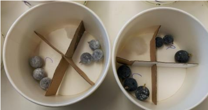
Abbildung 3: Versuchsaufbau im Labor: Becher mit je 3 Trauben der Sorte Chambourcin und Prior und einem feuchten Stück Watte.
