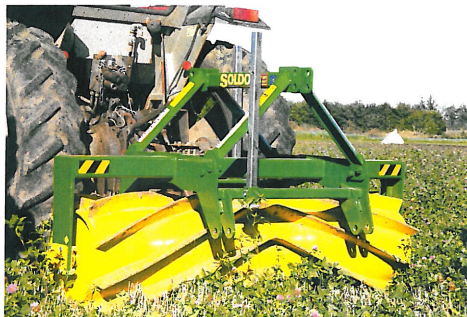
Knivtromlen af mærket Soldo, model RC200, i funktion i en rødskovafgrøde.
