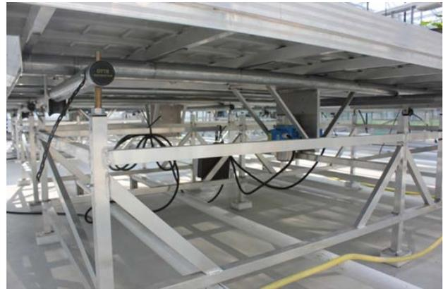
Abb. 7: Vibrations-Rolltisch mit Unwuchtmotoren (von unten)
