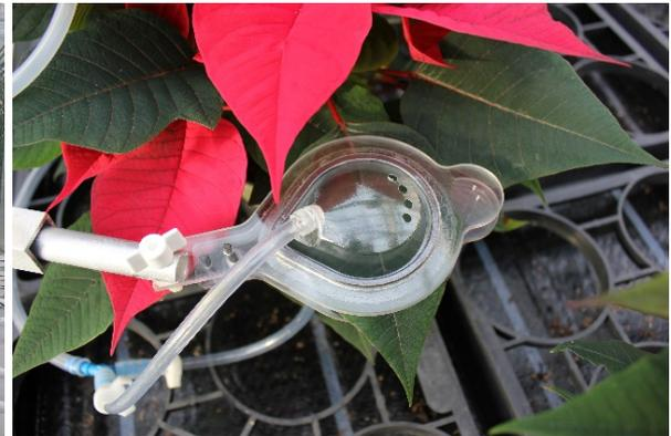
Abb. 32: Blattküvette zur Gaswechsellmessung an *Euphorbia pulcherrima* 'Bella Italia Red', 2013
