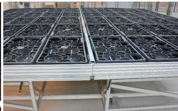
Abb. 25: gekoppelter Vibrationstisch mit Aluminium-Profilsschiene
