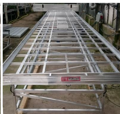
Abb. 10: Vibrations-Rolltisch (9,5 m x 1,61 m) im Praxisbetrieb Fleischle, 2016
