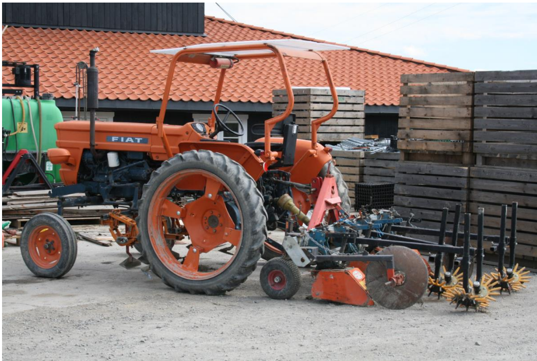
Lett utstyr reduserer kjøreskadene. Kombinasjon av mange typer skjær gjør radrensingen effektiv. Foto: Kari Bysveen
