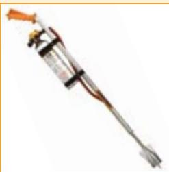
**Funktionsweise:** Über einen Metalldorn und ein Drahtgewebe von 10 cm Durchmesser wird Strahlungshitze ins Herz der Ampferpflanze abgegeben. Die Hitze denaturiert das Pflanzeneiweiß und zerstört die Zellstruktur. Das Gerät ist mit 1,6 kg Gewicht handlich und verbraucht mit 100 g pro Stunde wenig Gas.
