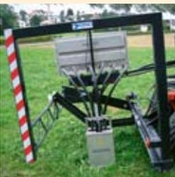
**Funktionsweise:** Mikrowellen werden in den Ampferstock und den angrenzenden Boden ausgesandt und denaturieren die wasserreichen Wurzeln. Ein 100 kg schwerer Prototyp ist an der Schweizer Forschungsanstalt Agroscope Reckenholz-Tänikon ART entwickelt worden.
