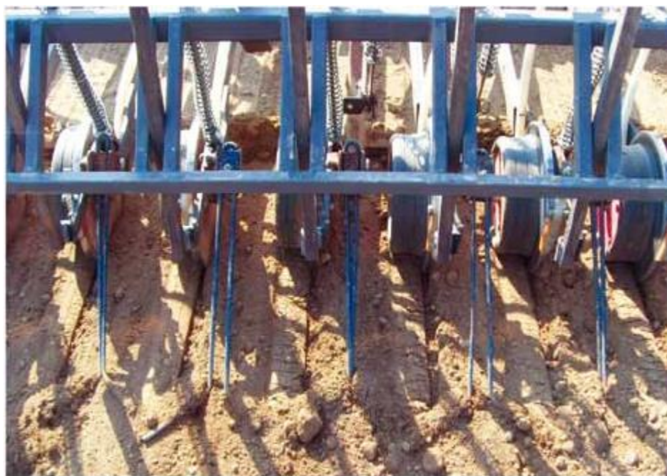
Joonis 3.4.4: Külvamine ilma külgsuunas nihkumisteta, täpselt määratud sügavusele.
