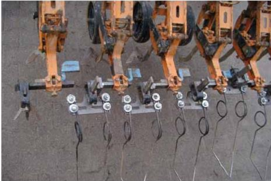
Joonis 3.5.2: Torsioonelemendid kinnituvad külgmistele harudele eespool, keskmises hoidikus on kinnitatud hanijalg otsikud.
