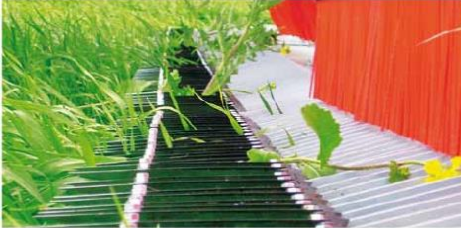
Joonis 5.5.4: Lõikurit võib võrrelda ettepoole suunatud nugadega kammiga. Peenikesed painduvad viljakõrred lähevad nugade vahelt läbi ilma vigastusteta. Jäigad paksud umbrohuvarred lõigatakse läbi.
