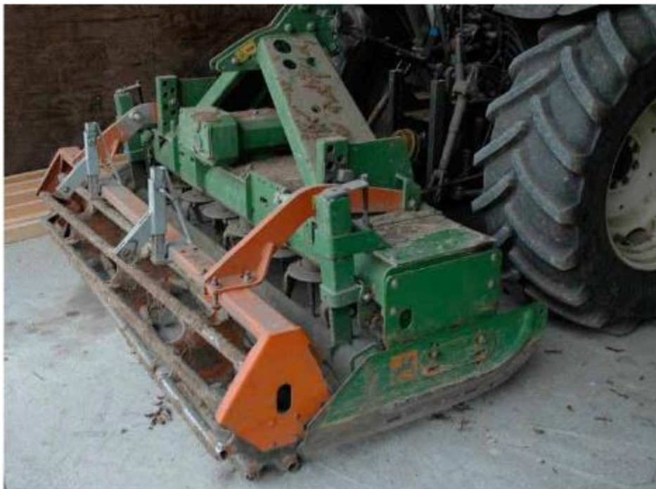
Joonis 2.4.1: Ettevõtte T1 kasutab rootorkultivaatorit ja freesi (ei ole fotol) maksimaalse sügavusega 6 cm.
