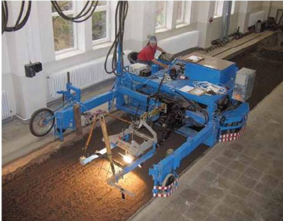
Joonis 4.1.1: Seadmete järjestus mullaosakeste heitetrajektoorie vaatlemiseks äestamisel, siin: heitelaius (kaamera vaade ülalt).
