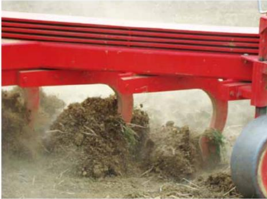
Joonis 2.4.2: Ettevõtte T2 kasutab mullaharimiseks kergatra.
