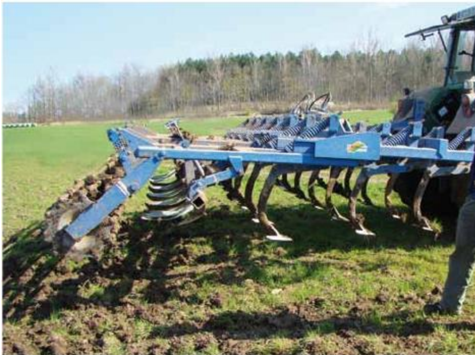
Joonis 2.4.4: Ettevõtte T3 kasutab kolme reaga hanijalg-kultivaatorit.
