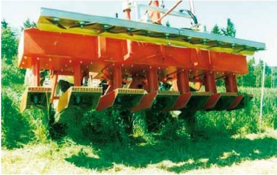
Joonis 5.3.1: Reavahede multšija tööorganid.
