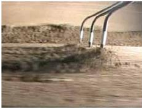
Joonis 4.1.3: Mullaosakeste lennukõrgus äestamisel töösügavusega 3 cm kiirustel 4 km/h ja 8 km/h. Valged markeeringud äkkepiidel vastavad kaugusele 2,5 cm.
