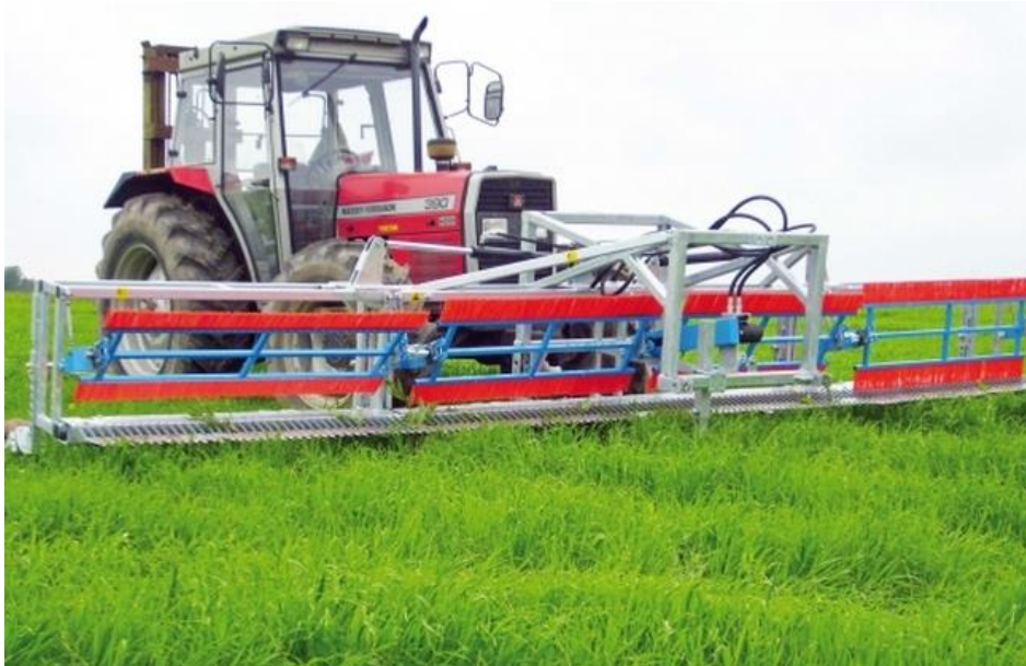
Joonis 5.4.1: Weed Cutter CombCut on kerge seade, mis haagitakse traktori ette.
