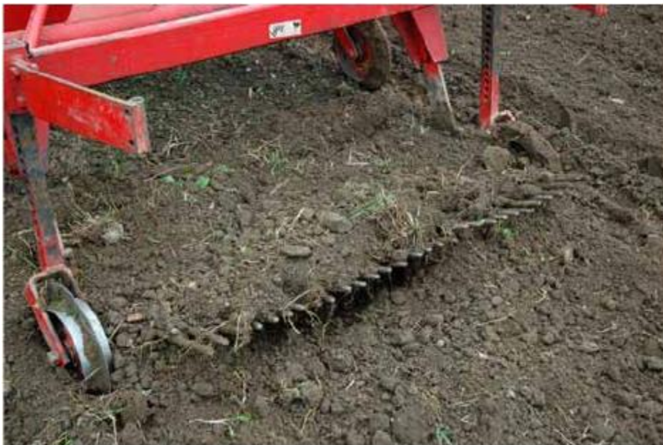
Joonis 2.6.4: Juurimismasin tõmbab juured pealispinnale.
