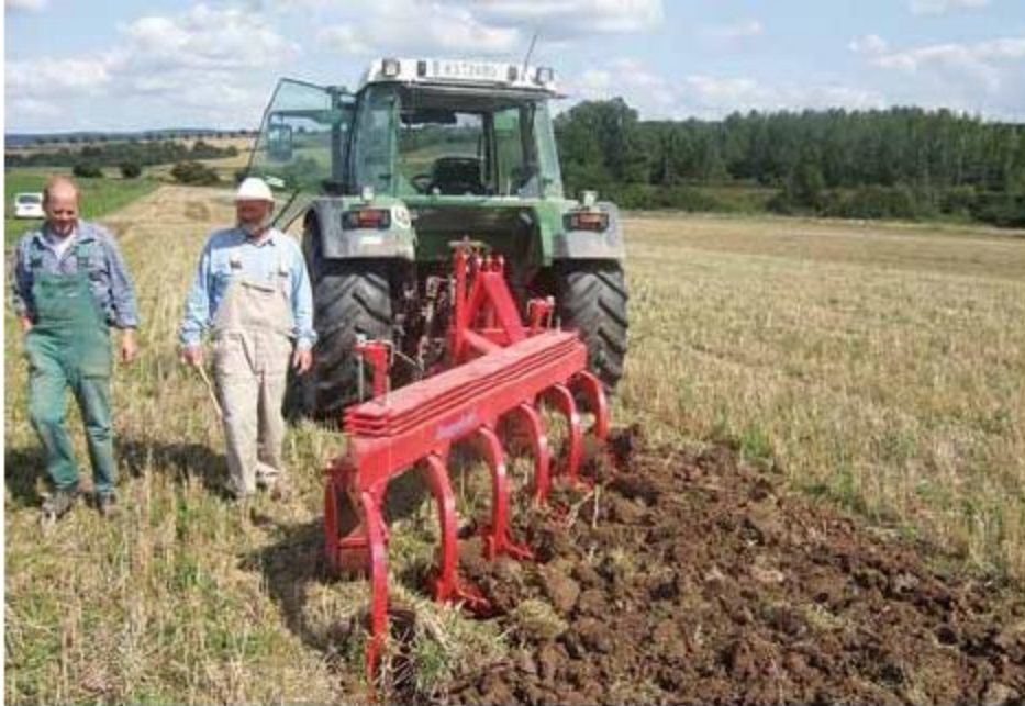
Joonis 2.3.1: Firma Zobel kuue hõlmaga kergadra proovikasutus katse alguses (operaatorid: M. Otto ja E. Kölsch)
