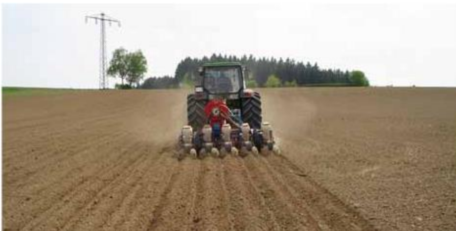
Joonis 4.2.2: Külvipinna ettevalmistamine kultivaatori ja randaaliga.
