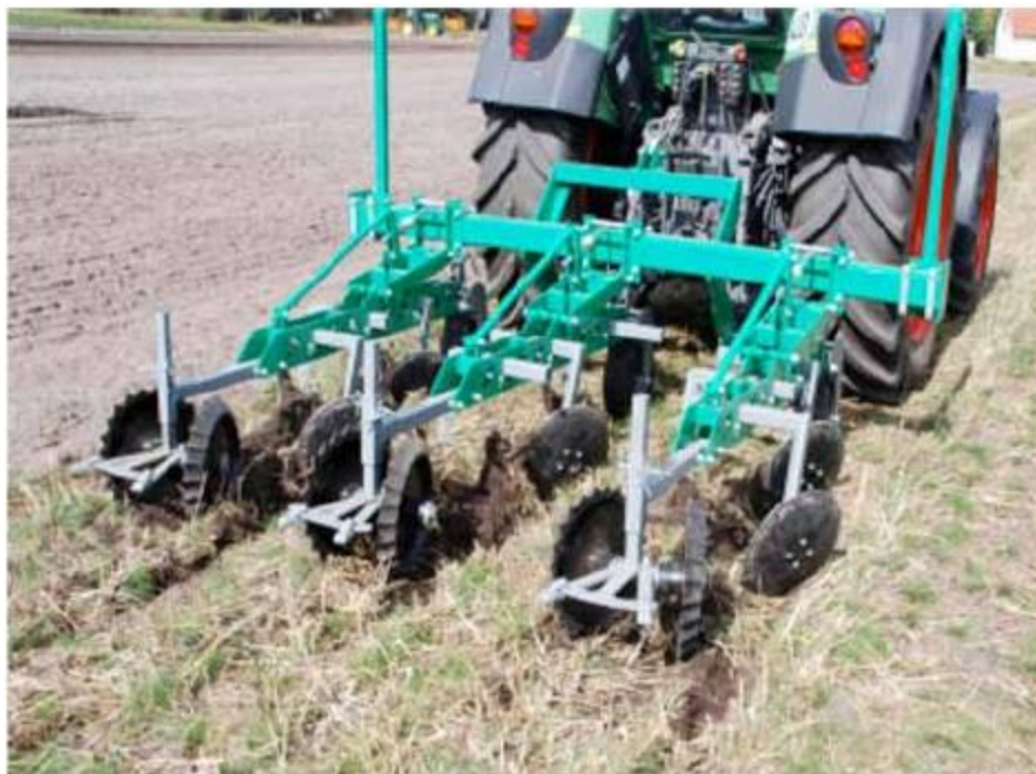
Joonis 4.12.1: EuM-Agrotec'i ketaskultivaator traktori järel.
