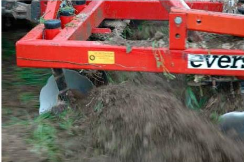
Joonis 2.6.3: Randaaliga saab töödelda suurt kogust mulda.
