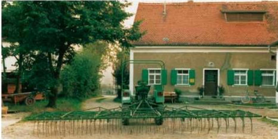
Joonis 4.2.1: Selle kerge äkke disainis ja ehtas hr Niedermaier ise oma töökojas.
