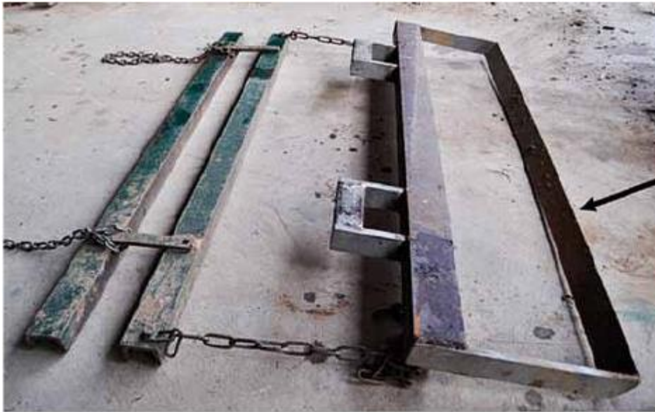
Joonis 2.5.2: Alt lõikamise nuga: tegelik nuga (vt noolt) oli algselt vedruterasest, nüüd kokkuhoiu mõttes harilikust ehitusterasest. Üks võimalus oleks kasutada meetri kaupa müüdavaid frontaallaaduri kopa siine (Foto: A. Müller).
