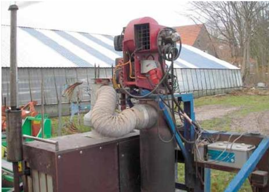
Joonis 3.1.5: Voolu tootmiseks on korpusesse integreeritud mürasolatsiooniga diiselmootor. Õlipõleti on monteeritud otse põlemiskambri peale.
