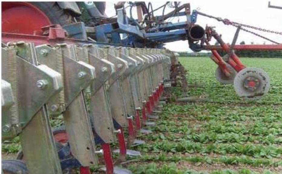
Joonis 3.4.1: Hanijalg-kultivaator spinatipõllul.
