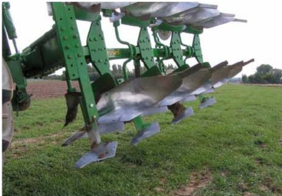
Joonis 2.2.2: Katses kasutatud adra ehitus. Kobestamisorganeid adralehtede all saab valikuliselt maha monteerida ja neid ei kasutatud igal aastal.
