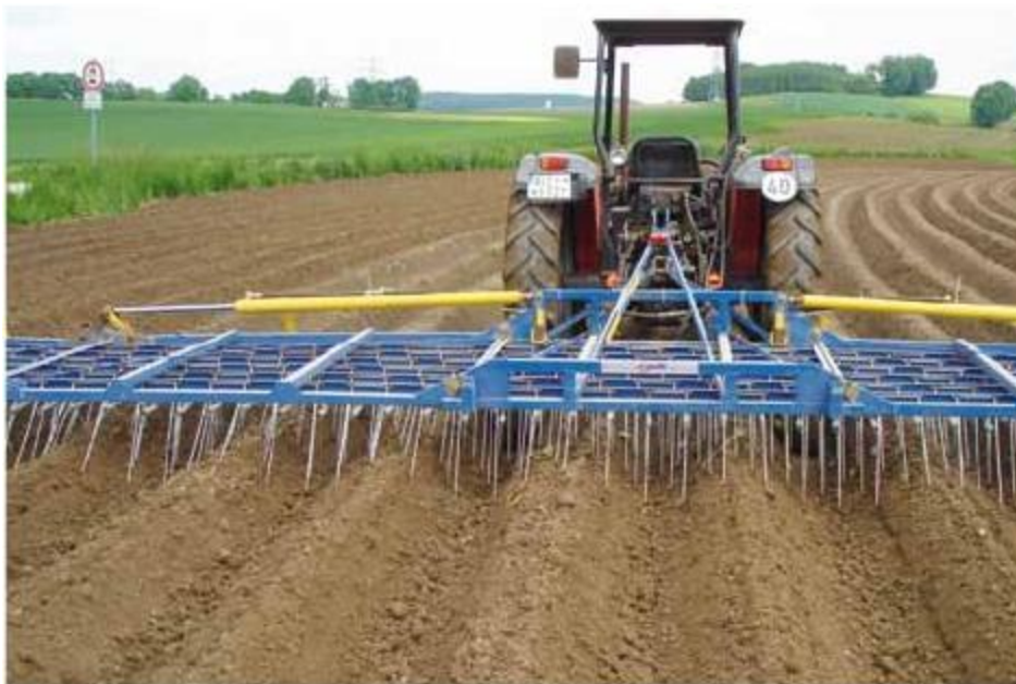
Joonis 4.2.4: Kartulivagude äestamine. Fotol on väga hästi näha, kuidas äkkepiid kohanduvad erinevatele mullatingimustele. Nii saab mehaanilist umbrohutõrjet teha ka vaokülgedel.
