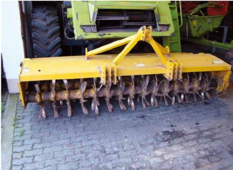
Joonis 2.4.5: Dyna Drive võimaldab töödelda väga pindmiselt (1–2 cm).
