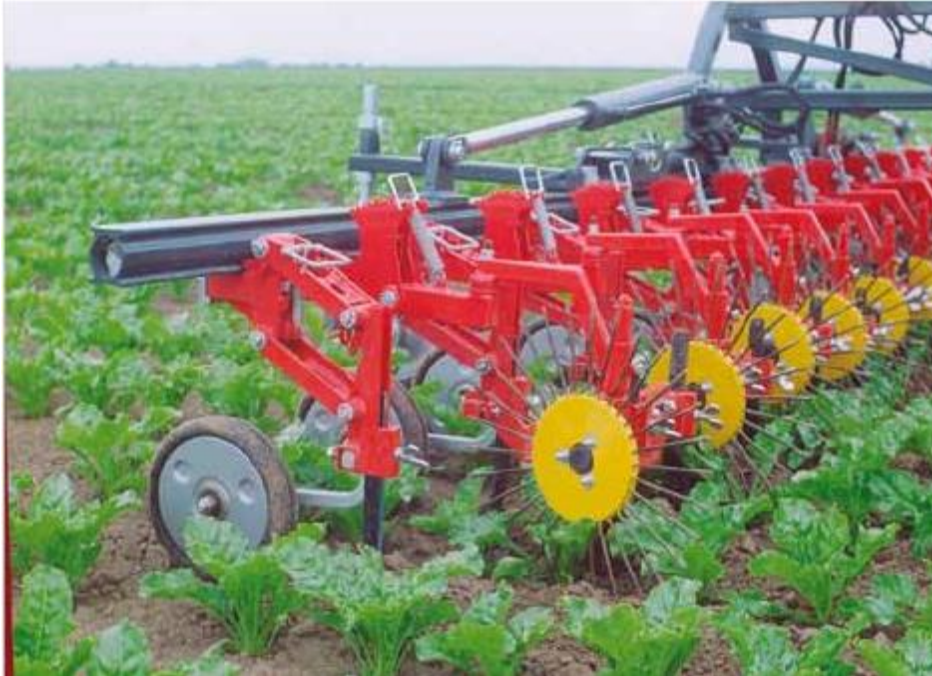
Joonis 4.3.1: Vaheltharimistera ja tähtäkke kombinatsioon (Annaburger Uni-Hacke) suhkrupeedipõllul töötamas (Foto: Rumpler).
