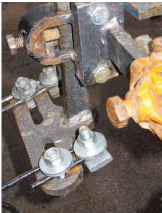
Joonis 3.5.3: Hoidiku põhjaplaat võeti lahti ja keevitati ca 105-kraadise nurga all tagasi (algne nurk 90°).
