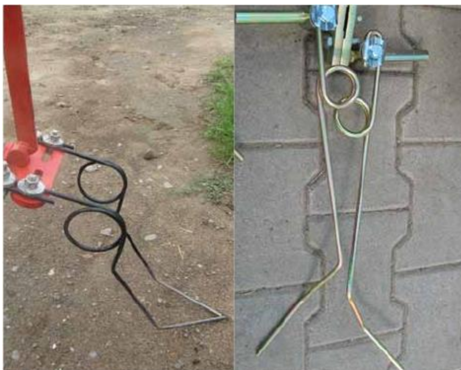
Joonis 3.5.4: Vasakul: reguleeritav hoidik, mida firma Frato nõudluse tõttu toodab. Siin on telje ristlõige 10 x 30 mm. Paremal: Teise tootja torsioonäke (10 x 30 mm). Äkkepulkade kallet saab seada ümmarguse telje kaudu kruvi abil niihästi alla mulla poole kui ka külgsuunas taime poole (tarnija: firma Kress).
