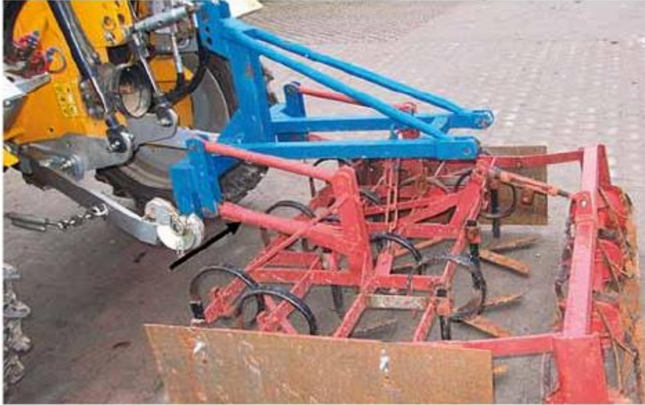
Joonis 2.5.4: Ümber ehitatud Guttleri kultivaator-äkkest. Kõrguse juhtimiseks on tagumine rullik ja ülemine juhtseade, parallelogramm (vt noolt) toetab kõrguse juhtimist ebatasasuste korral.
