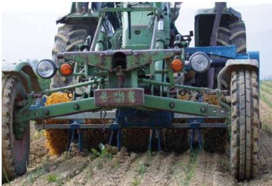
Joonis 3.4.3: Vaheltharimishari kisub umbrohu hästi välja. Puuduseks on see, et masin ei kohandu mulla ebatasasustega (seetõttu peavad peenrad olema ühetasased) ja meetodit saab kasutada ainult kultuurtaimede varases kasvufaasis (ehk siis kui lehemass on väike).
