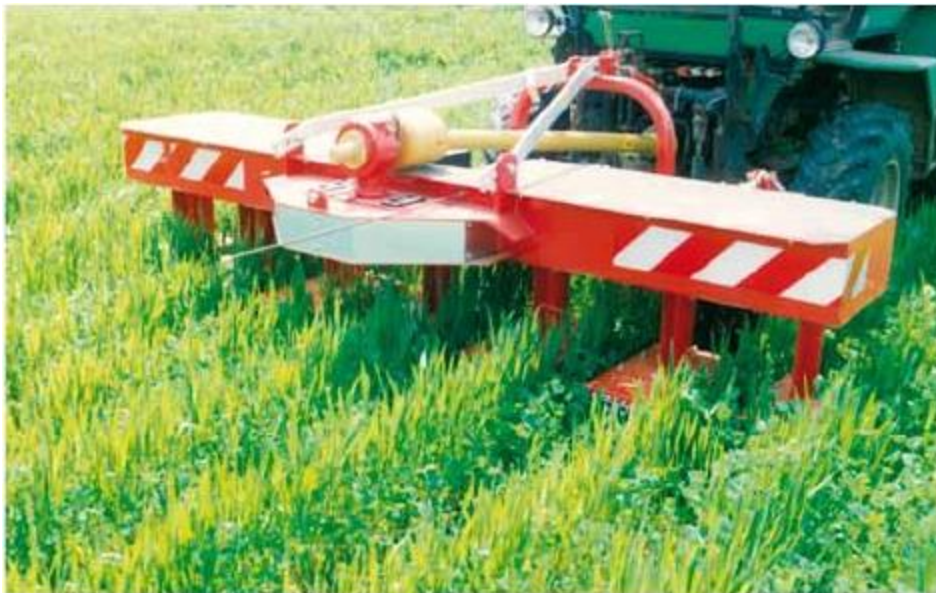
Joonis 5.3.2: Reavahede multšija kasutamine reavahega 50 cm varajases staadiumis.
