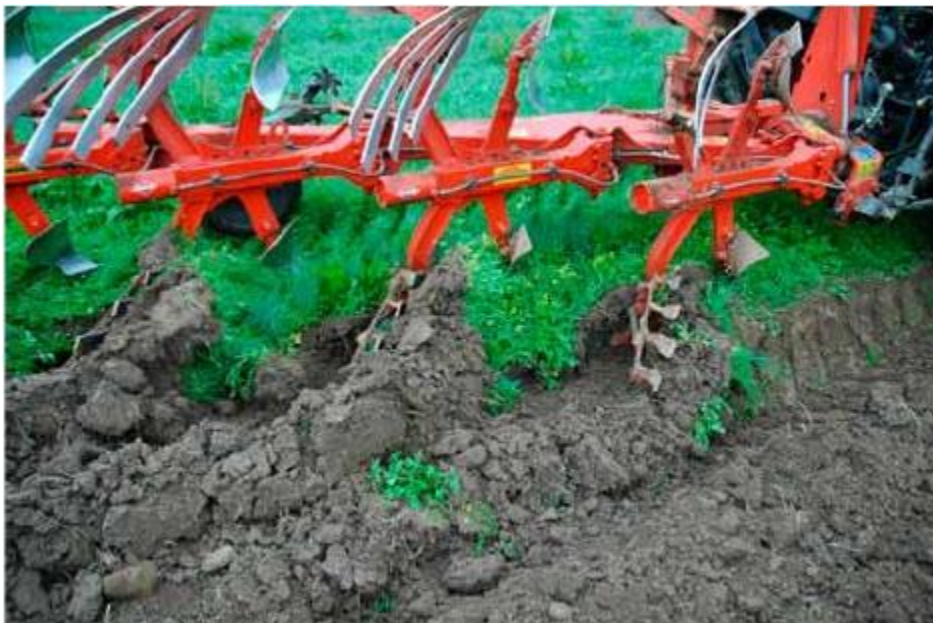
Joonis 2.6.2 Ilma kõrrekoorijata ei aja ader kuigi palju metskersijuuri sügavale mulla alla.
