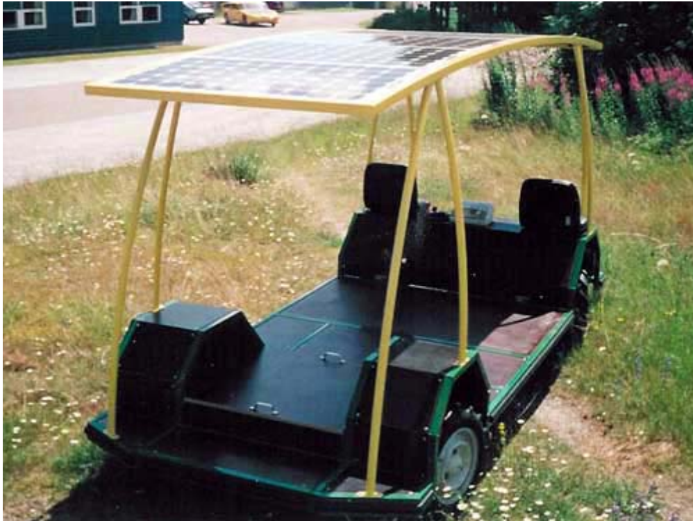
Figur 5.3 Solvognen "Greentrac" til brug ved plantning, lugning og høst af grønsager
