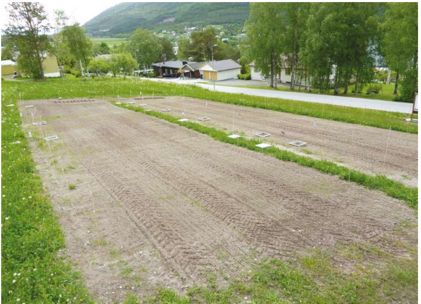
Figur 1. Måling av lystgass ble utført i kasser i feltforsøket i SoilEffects 2012, her i åkerdelen av forsøksfeltet. Foto: Anne-Kristin Løes.
