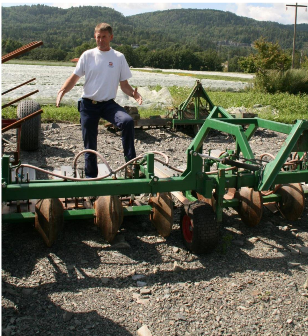
Hans Ijærås har konstruert en propanbrenner som går over tre senger. Brenneren benyttes i gulrot før den spirer, og i løk. Foto: Kari Bysveen
