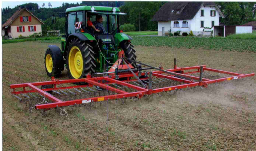
La herse flexible se prête bien à un usage précoce pour casser la croûte du sol et détruire les germes d'adventices.
